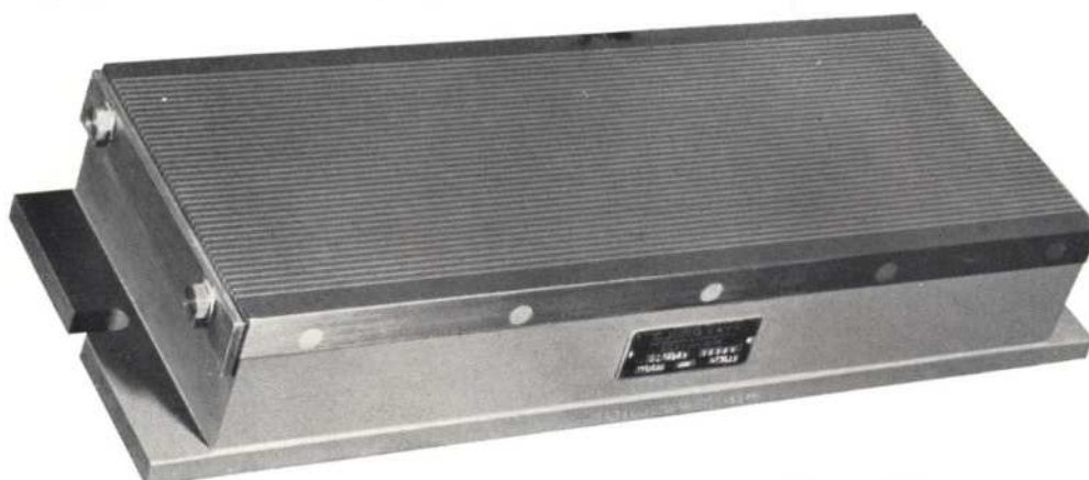
Bild 25: Elektro-magnetische Spannplatte mit enger Längspolteilung
